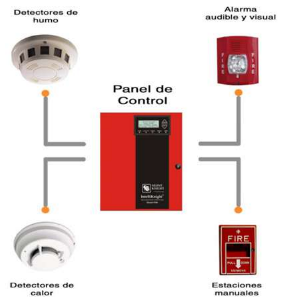
SISTEMA DE ALARMA Y DETECCIÓN
